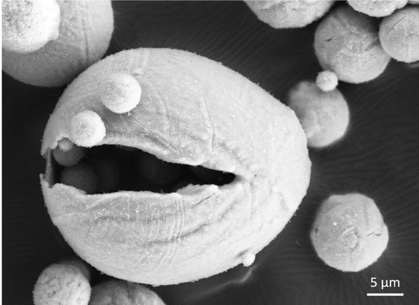
Verbrennung von Eisenpulver in einem Brenner im Industriemaßstab. Das Pulver wird als nachhaltiger Energieträger verwendet. Copyright: Laurine Choisez, Max-Planck-Institut für Eisenforschung GmbH
