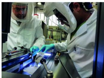
**Abb.1:** Eric Jäggle (links), Leiter der Gruppe „Legierungen für die additive Fertigung“, und Priyanshu Bajaj, Doktorand in der Gruppe, befüllen die Kammer des 3D-Druckers mit Metallpulver. Dieses ist so feinkörnig, dass es leicht eingeatmet werden könnte. Um dieses Risiko zu vermeiden, tragen die Wissenschaftler eine entsprechende Schutzkleidung.
