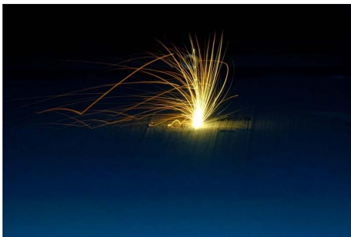
Einblick in die Kammer eines 3D-Druckers: Ein Laserstrahl fährt durch ein Pulverbett aus Metall und erzeugt so Schicht für Schicht das gewünschte 3D-Produkt. Foto: Philipp Kürnsteiner, Max-Planck-Institut für Eisenforschung GmbH
