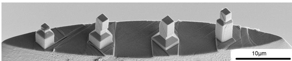
Die elektronenmikroskopische Abbildung zeigt vier verformte Mikrodruckproben auf einer Kupfer-Lamelle. Die Breite der Lamelle entspricht der Dicke eines menschlichen Haares, der Probendurchmesser ist noch einmal ein Zwanzigstel kleiner. Mit Hilfe solcher Druckproben kann das mechanische Verhalten einzelner Mikroelektronikkomponenten verstanden werden.
