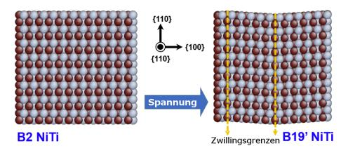
Das Bild zeigt wie sich die atomare Anordnung in einem Nickel-Titan (NiTi)-Material ändert, wenn eine äußere Spannung angelegt wird. Die ursprüngliche B2 NiTi-Phase (linkes Bild) verändert sich dabei zu einer sogenannten B19' NiTi-Phase (rechtes Bild), die sich durch Zwillingsgrenzen auszeichnet. Die Zwillinge (jeweils links und
