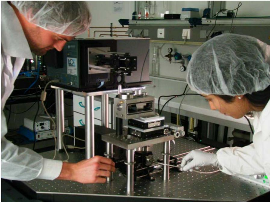
Thomas Utzig und Dr. Sangeetha Raman bei ihrem Versuchsaufbau zur Messung von Enthaftungsprozessen. Das Bild zeigt ein sogenanntes Rasterkraftmikroskop. Bild: Dr. Markus Valtiner, Max-Planck-Institut für Eisenforschung GmbH
